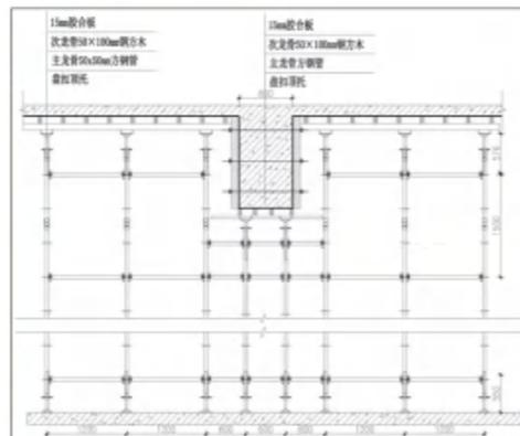
$0.72\text{m}^2 < \text{截面面积} \leq 1.095\text{m}^2$ 的梁支撑体系
