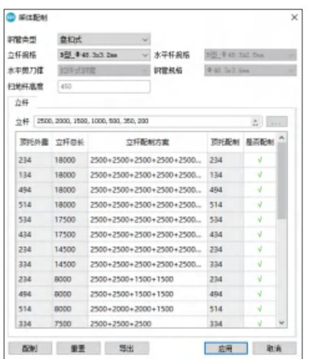
▲ 按材料长度进行杆件拆分组合, 龙骨考虑搭接长度
