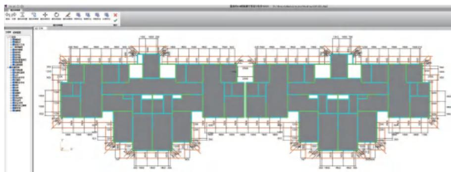
钢梁及立杆定位手动调整, 完成外架最终设计 ▲
