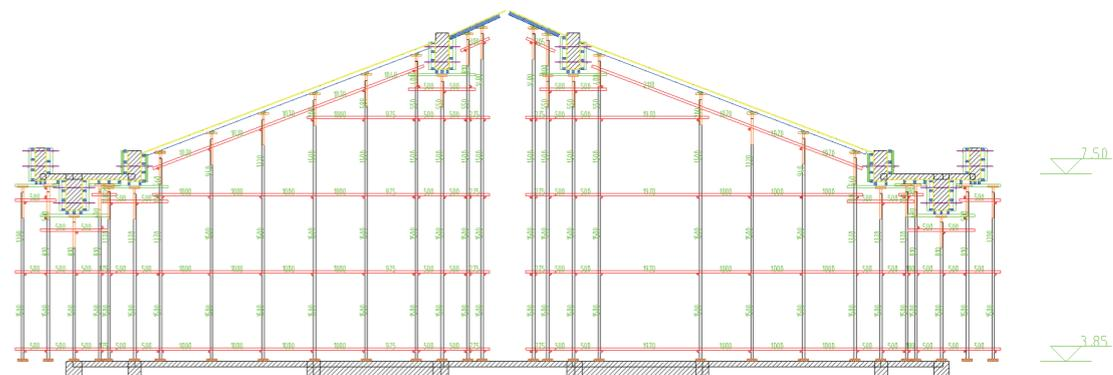
坡屋面支撑架剖面图 ▲
